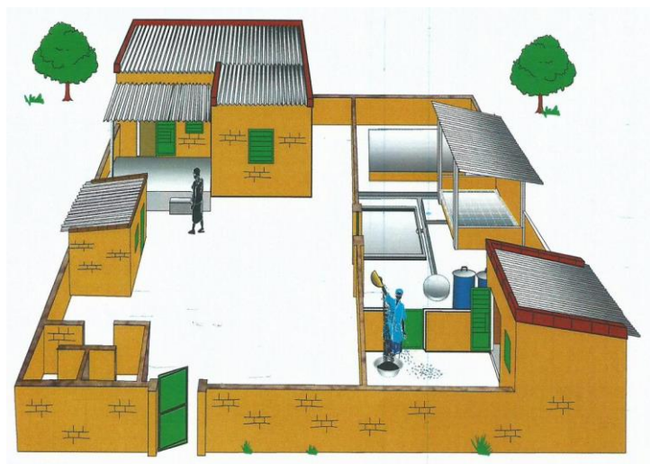
Figure 26 – Bonne implantation d’une unité de transformation dans la maison d’habitation
