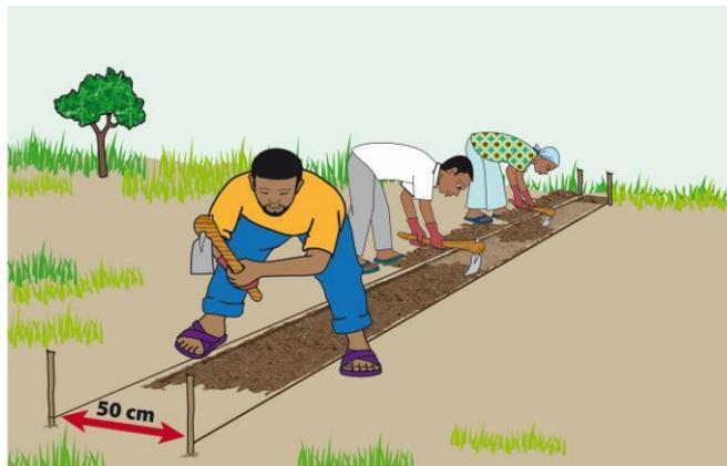
***Dessin 20 : Ancrage et mesure base de la diguette***
