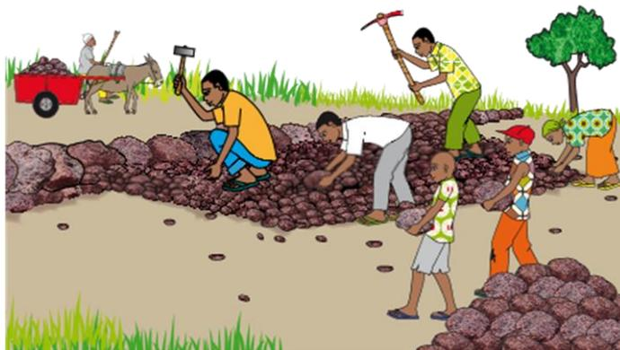
**Dessin 17 : Diguette filtrante en construction**
