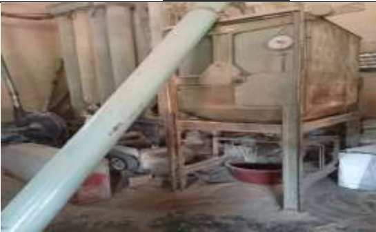
Photo 17 : Silo de stockage pour les graines
