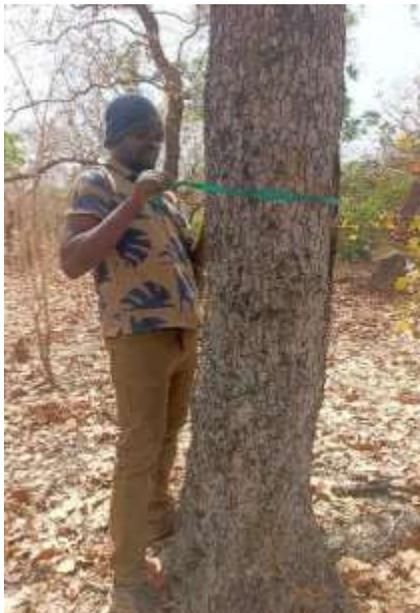
Photo 5 : Mesure de la circonférence d'un arbre dans une placette
